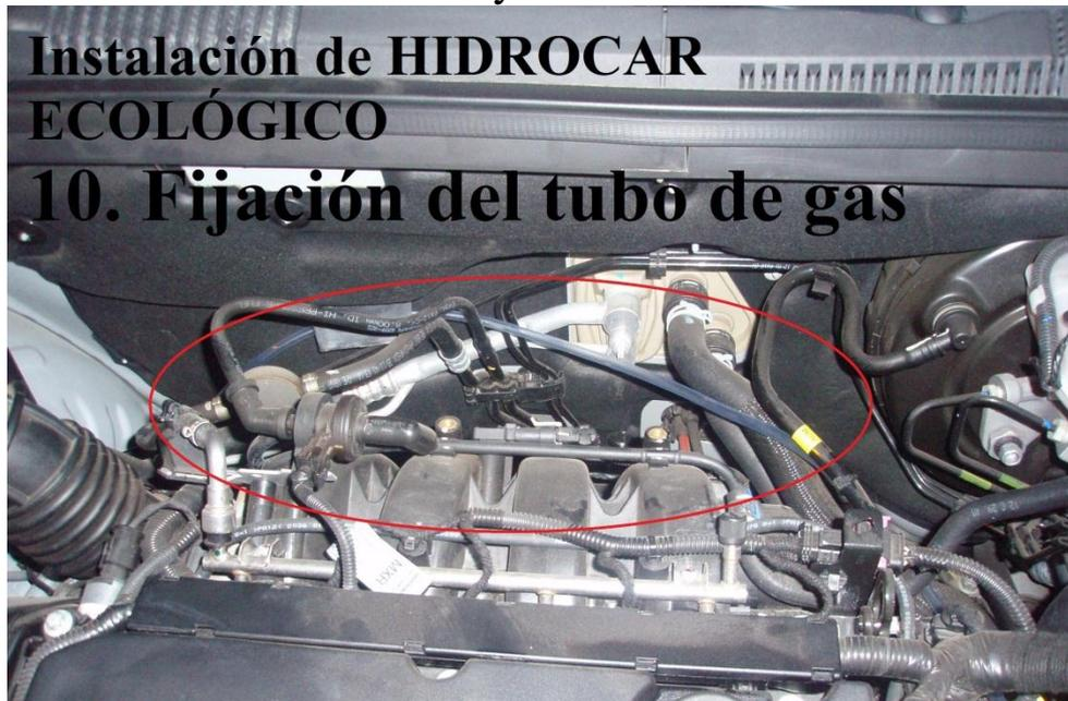
En este momento se recomienda purgar el posible agua e impurezas que pudiera tener el conducto de hidrógeno activando el sistema y haciéndolo funcionar unos minutos produciendo hidrógeno con la goma introducida en una botella de agua.
