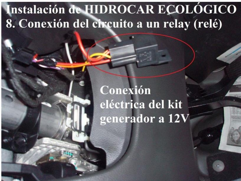
*Nota: la conexión eléctrica debe realizarse de manera que soporte el amperaje de los dispositivos hidrogeneradores. Véase en la **página 10** la tabla de las especificaciones técnicas para calcular el amperaje consumido.*
